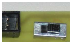
Abbildung 4.7: Schiebeschalter für die Bootloaderaktivierung (Position „Bootloader“)
