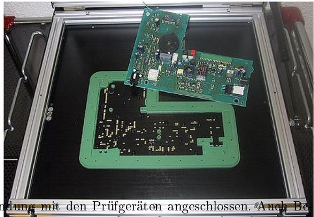
Die Nadeln sind mit einer Relais-Matrix zur Verbindung mit den Prüfgeräten angeschlossen. Auch Bestückungsfehler lassen sich überwiegend mit Zweipunktmessungen von Strom-Spannungsbeziehungen erkennen. Fehlerlokalisierung im Vergleich zu der für einen dynamischen Test, der versagt, sehr einfach.
