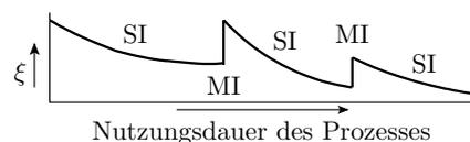
Bei der Einführung neuer Maschinen, Verfahren, ... kommen Fehler in den Prozess und erhöhen die Fehlerentstehungsrate. Mit der Prozessnutzung werden diese Fehler und Schwachstellen beseitigt, so dass die Fehlerentstehungsrate abnimmt, bis die nächste grosse Neuerung eingeführt wird. Neuerungen haben oft geringere störungsbedingte Fehlerentstehungsraten, so dass die Fehlerentstehungsrate und damit der Defektanteil über mehrere »Sägezähne« abnimmt.
