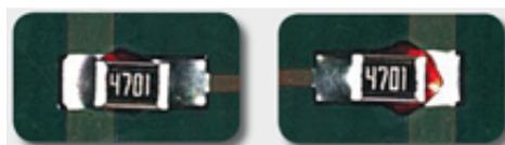
Nachweis nur durch visuelle Kontrolle möglich. Nach Ausfall der Baugruppe z.B. durch Vibration in einem Fahrzeug ist sofort erkennbar, dass es sich um einen Fertigungsfehler handelt.
