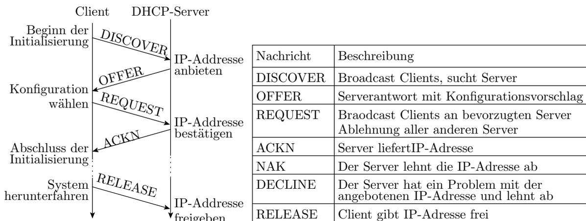
Sequenzdiagramme sind Interaktionsdiagramme und zeigen Ablaufbeispiele für den Nachrichtenaustausch zwischen Objekten, Threads, Rechnern, ... in einer zeitlich begrenzten Situation. Dabei kann auch das Erzeugen und Entfernen von Objekten enthalten sein.
