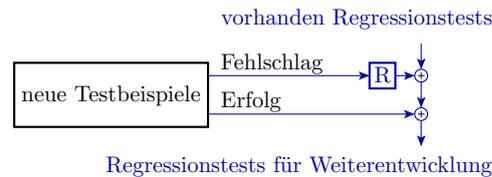
Akkumulation von Regressionstests ( $\oplus$ ): Erfolgreiche Tests werden gesammelt und nach jeder Änderung als Regressionstest wiederholt. Wenn ein Regressionstest nach einer Änderung fehlschlägt, (Phantom-) Fehlerbeseitigung.
