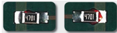
Bild links korrekt bestückter SMD-Widerstand, rechts Lötfläche durch Kleber verschmutzt. Elektrisch leitende aber keine feste Lötverbindung. Nachweis nur durch visuelle Kontrolle möglich. Nach Ausfall der Baugruppe z.B. durch Vibration in einem Fahrzeug ist sofort erkennbar, dass es sich um einen optisch nachweisbaren Fertigungsfehler handelt.
