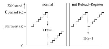
Zählen von Ereignissen, Setzen eines Interruptanforderungsflags bei Überlauf. Mögliche Zählereignisse:
