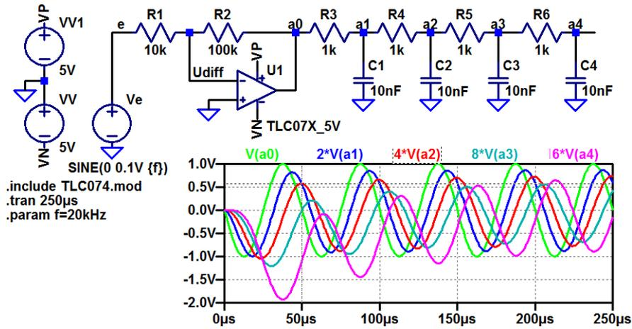
Jedes RC-Glied halbiert etwa das Ausgangssignal und verzögert es um  $\approx 45^\circ$ .
