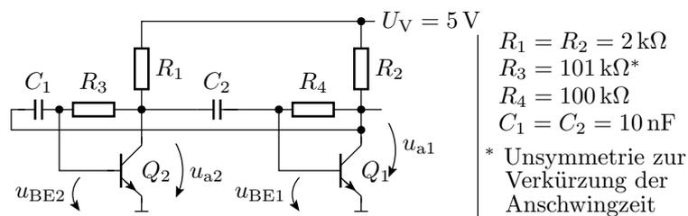
Ohne  $C_1$  und  $C_2$  arbeiten beide Transistoren im Normalbereich. Ausgangsspannung  $\approx 1,31\text{ V}$  (siehe nächste Folie). Eine fallende Flanke am Kondensatoreingang schaltet den nachfolgenden Transistor bis zum Umladen des Kondensators aus und eine steigende schaltet ihn voll ein.
