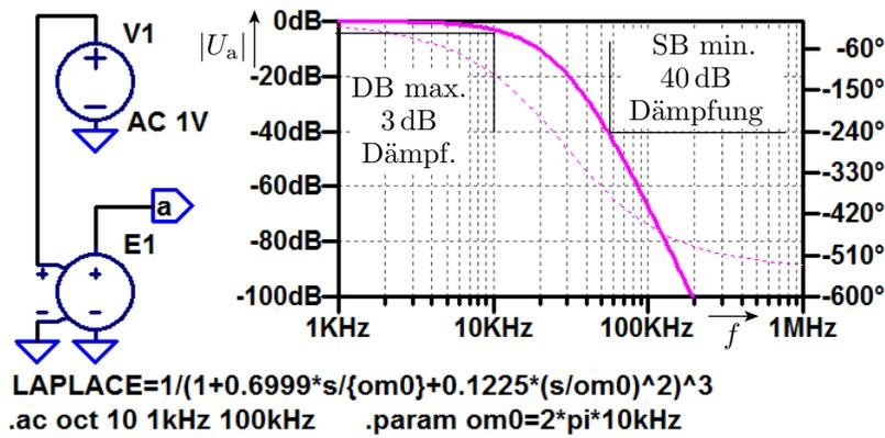
Das Durchlassband endet bei 10 kHz und das Sperrband fängt bei 50 kHz an.
