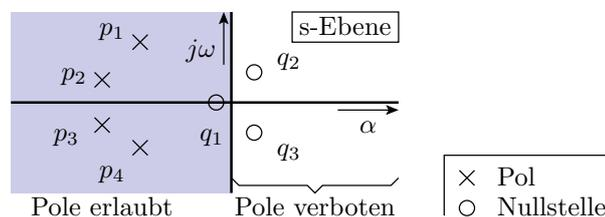
Aus den Abständen und Winkeln der Pole und Nullstellen zu einer Frequenz auf der Frequenzachse lassen sich Betrag und Phase abschätzen.
