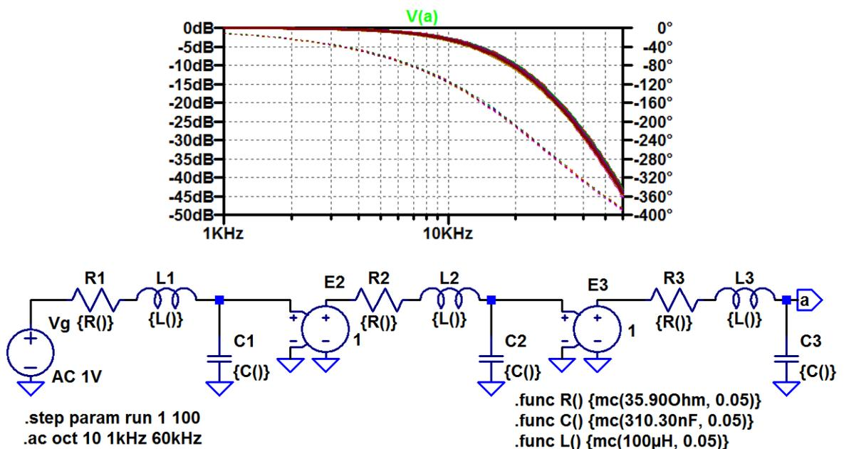
Die Funktionen R(), C() und L() erzeugen Zufallswerte im Bereich  $\pm 5\%$  vom Nennwert. Die Step-Anweisung wiederholt die Simulation 100 mal.
