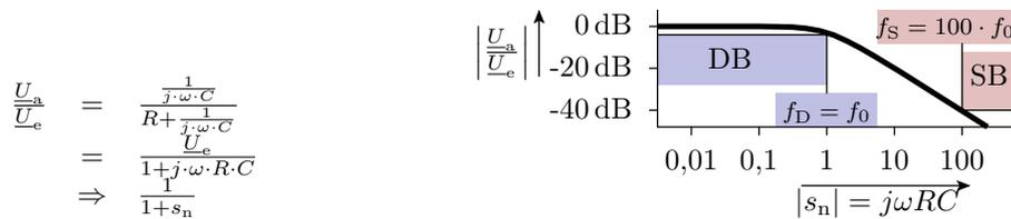
Bei geforderter Mindestdämpfung im Sperrband von 40 dB ist die Anfangsfrequenz des Sperrbands 100-mal so groß wie die obere Frequenz des Durchlassbands. Zur Digitalisierung müsste die Abtastfrequenz  $200 \cdot f_0$  sein. Abstandsverringern durch Erhöhung der Filterordnung  $N$ . Verkettung von zwei RC-Gliedern.
