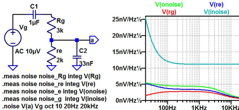
Bei einer frequenzabhängigen Übertragungsfunktion sind auch die Verstärkungen und Dämpfungen der Rauschteile frequenzabhängig. Die äquivalente Eingangsruschdichte ist unterhalb des genutzten Frequenzbereichs deshalb so groß, weil dort die Verstärkung, durch die dividiert wird, klein ist.
