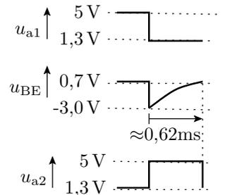
Wenn Transistor  $Q_2$  einschaltet, schaltet  $Q_1$  für eine Zeit  $t_1$  aus.
