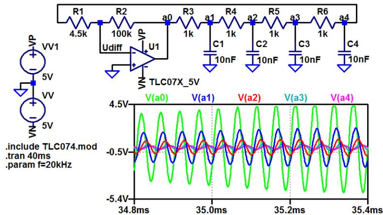
Genau genommen entsteht ein aufschwingendes Signal (Verstärkung mal Dämpfung  $> 1$ ), das ab einer bestimmten Amplitude durch die Versorgungsspannung begrenzt wird.
