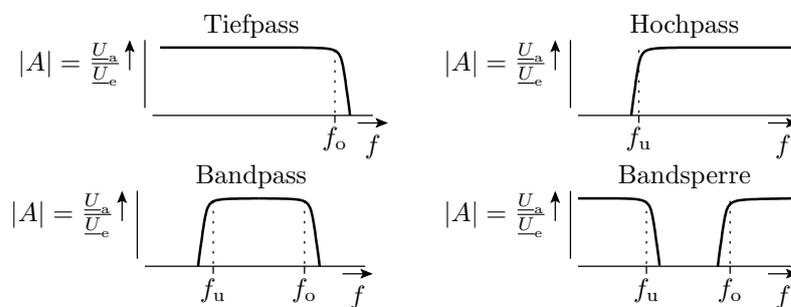
Tiefpässe dienen z.B. als Antialiasing-Filter<sup>5</sup> vor der Abtastung, Bandpässe zur Sendertrennung beim Rundfunk- und Fernsehempfang. Entwurf im Laplace-Raum ( $s$  statt  $j\omega$ ).
