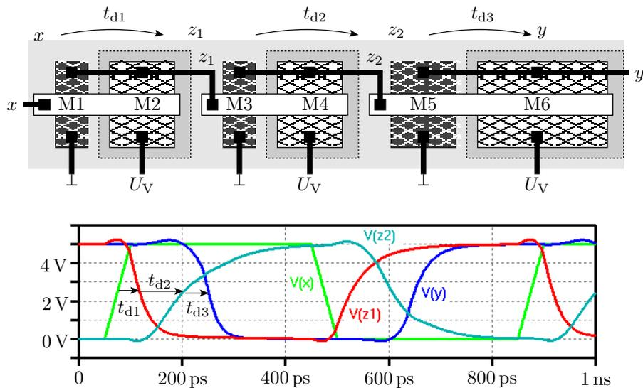
Die Verzögerung  $t_{d1}$  des ersten Inverters ist deutlich kürzer als  $t_{d2}$  des zweiten Inverters mit der doppelten Last und  $t_{d3}$  ist wieder kürzer, da ohne Last.
