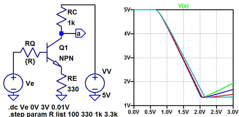
Für  $R_Q$  im gesamten variierten Bereich von  $100 \Omega$  bis  $3,3k\Omega$  ist  $U_e = 1,4V$  ein guter Arbeitspunkt.
