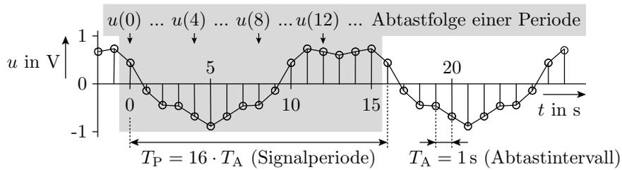
Berechnung von  $N$  Spektralwerten aus  $N$  äquidistanten Abtastpunkten eines bandbegrenzten Signals. Abtasttheorem:
