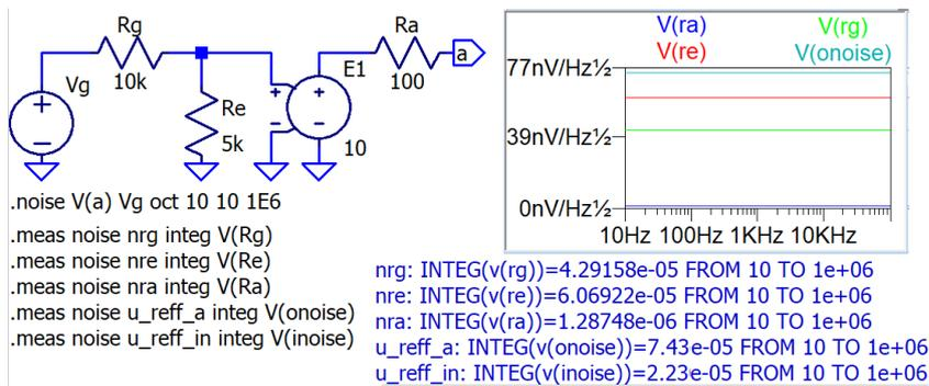
Der Signalrauschabstand für  $U_{\text{eff.g}} = 100\ \mu\text{V}$ :
