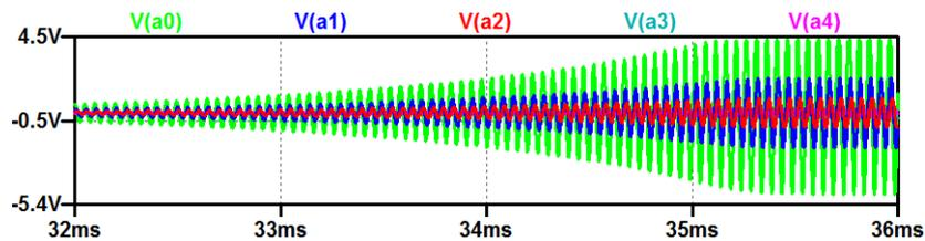
Durch die Begrenzung wird das Sinussignal verzerrt. Ein guter Sinusgenerator regelt, wenn die gewünschte Amplitude erreicht ist, die Verstärkung zurück.
