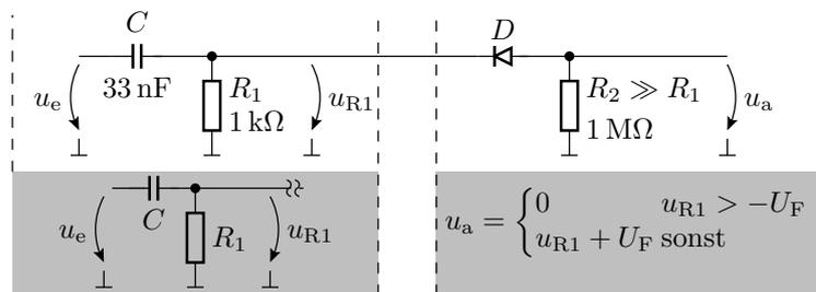
Konstruktion der Ersatzschaltung für Überschläge:
