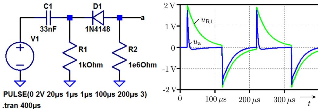
Abweichend vom geschätzten Ausgabesignalverlauf gibt es auch bei der steigenden Flanke am Ausgang einen Nadelimpuls mit der Zeitkonstanten  $\tau_2 \approx 4 \mu s$ . Das Simulationsmodell der Diode hat offenbar im Sperrbereich eine Kapazität von:
