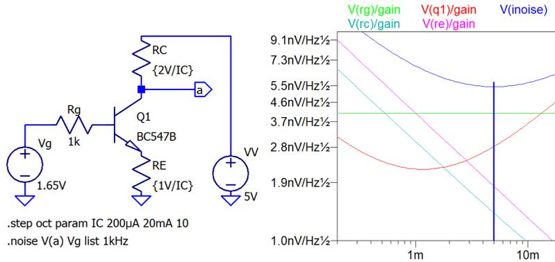
Die von 200  $\mu$ V bis 20 mV durchgestepte Variable IC legt  $R_C$  und  $R_E$  so fest, dass sich etwa Verstärkung 2 mit dem vorgegebenen Kollektorstrom »IC« einstellt. Es wird nur die Rauschdichte für 1 kHz geteilt durch die Verstärkung (äquivalente Eingangsrauschdichte).
