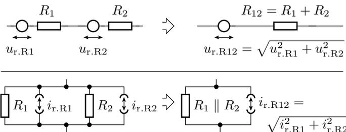
Wärmerauschdichte von zwei Widerständen in Reihe:
