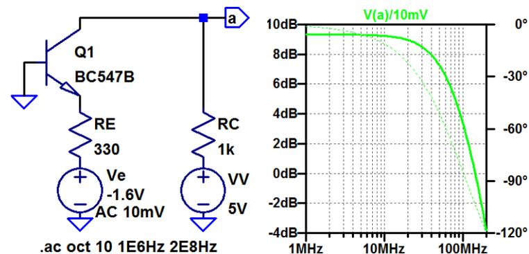
Der Betrag der Verstärkung ist wie bei der Emitterschaltung ca. 9 dB. Die Übergangsfrequenz der Schaltung und die Transitfrequenz des Transistors liegt bei etwa 80...90 MHz.
