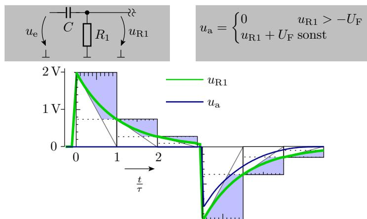
$u_{R1}$  hat nach dem Sprung als Anfangswert die Sprunghöhe (beim Ausschalten von  $u_e$  negativ) und strebt gegen null. Die Ausgangsspannung müsste bei positiven Eingangssprüngen null bleiben und bei negativen müsste ein Nadelimpuls erscheinen.
