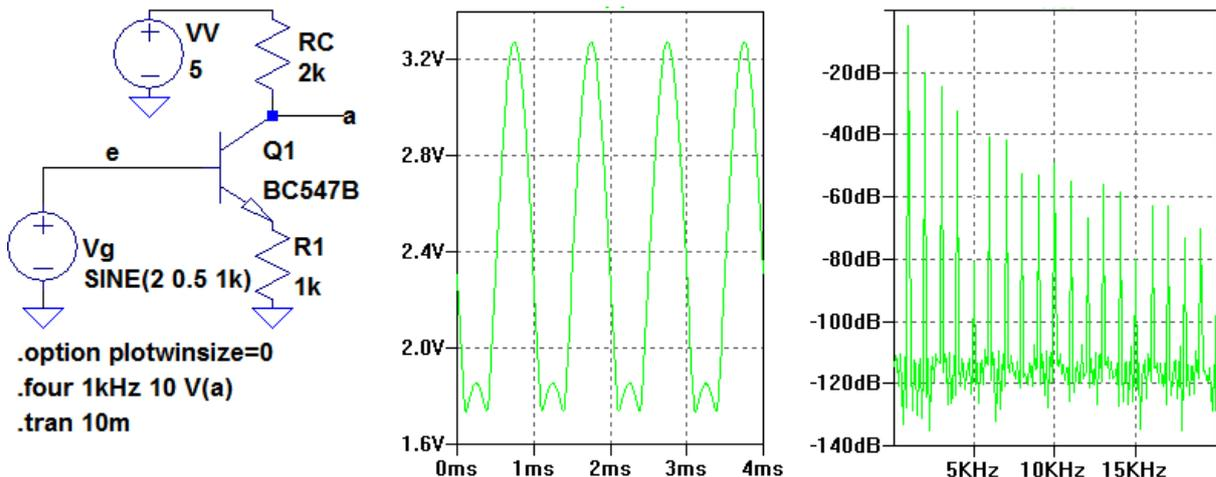
Das Eingangssignal ist  $U_g = 2V + 0,5V \cdot \sin(2\pi \cdot 1\text{kHz} \cdot t)$ . Für zu große Werte der Eingangsspannung geht der Transistor in die Übersteuerung. Die Verstärkung wechselt von -2 nach 1.
