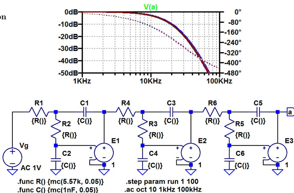
Die rückgekoppelten Operationsverstärker sind durch gesteuerte Spannungsquellen mit Verstärkung eins ersetzt.
