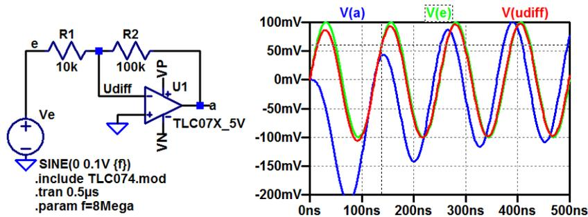
Bei 8 MHz sind Ein- und Ausgangssignal fast gleichphasig. Es kommt zu einer Mittkopplung. Die Verstärkung (Amplitude der Ausgangsspannung zur Amplitude der Differenzspannung) ist jedoch nur noch etwa eins. Wenn man  $R_2$  weglässt, ändert sich die Ausgangsspannung kaum.
