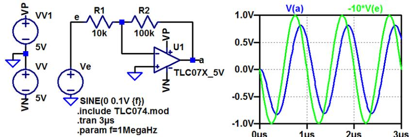
Invertierender Verstärker mit Verstärkung  $-R_2/R_1 = -10$  für niedrige Frequenzen. Im Bild bei 1 MHz ist die Verstärkung nur noch  $-8,15$  und das Ausgangssignal gegenüber dem Eingangssignal um 120 ns verzögert. Bei einer Verringerung der Signalperiode auf die doppelte Verzögerung  $T_P \approx 240$  ns müsste aus der Rückkopplung eine Mittkopplung werden?
