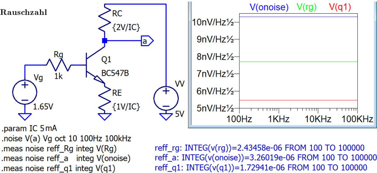
Für  $I_C = 5$  mA sind die Rauschdichten im betrachteten Frequenzbereich von 100 Hz bis 100 kHz konstant. Effektivwertanteile Ausgangsrauschen:
