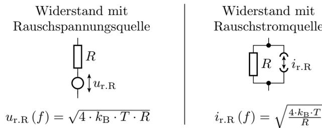
Die Rauschdichten der einzelnen Quellen werden in äquivalente Rauschdichten am Schaltungsein- oder Ausgang umgerechnet und zusammengefasst.
