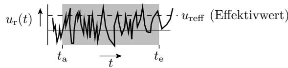
Rauschsignale werden durch ihren Effektivwert (Leistungsmittelwert), Abschätzung für das Zeitfenster  $[t_a, t_e]$
