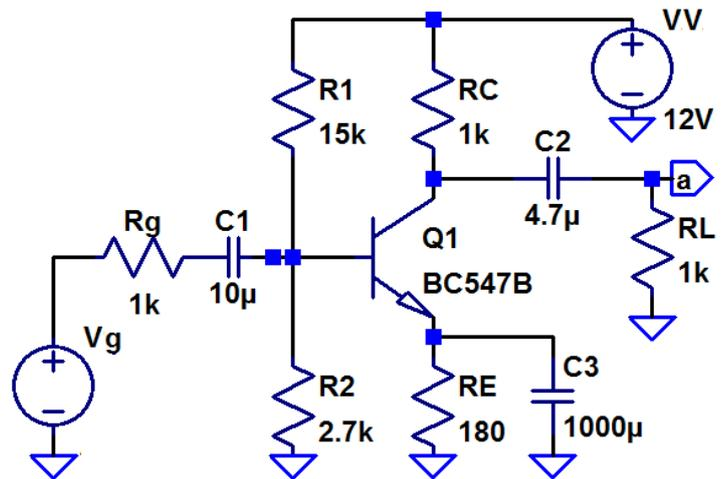
Kosinusförmiges Eingangssignal:  $u_g = 30 \mu\text{V} \cdot \cos(2 \cdot \pi \cdot 10 \text{ kHz})$ .
