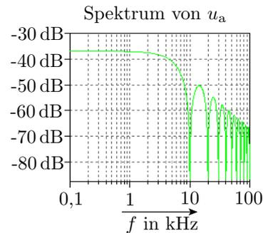
Für  $f < \frac{1}{2\pi \cdot t_{\text{Puls}}} = 1,6 \text{ kHz}$  ( $t_{\text{Puls}}$  – Pulsbreite)  $|U_a| = \text{konst.}$
