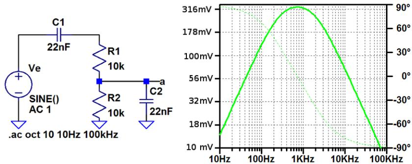
$$U_a = \frac{j\omega RC \cdot 1V}{1 + 3 \cdot j\omega RC - (\omega RC)^2} \quad \text{mit} \quad R \cdot C = 22 \text{ nF} \cdot 10 \text{ k}\Omega = 220 \mu\text{s}$$
