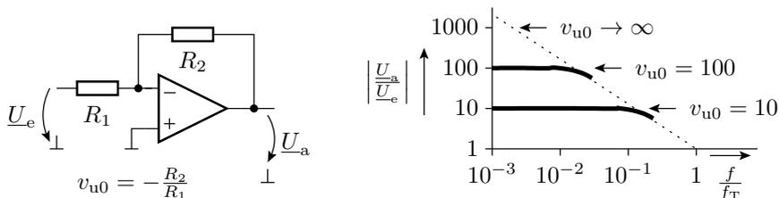
Die 8 MHz sind offenbar etwa die Transitfrequenz  $f_T$  des Operationsverstärkers, bei der die Verstärkung eins ist. Eine Verstärkung  $v_{u0} > 1$  ist nur für die Spektralanteile mit  $f < \frac{f_T}{v_{u0}}$  erreichbar. Rückgekoppelte Verstärker, bei denen die Verstärkung bei einer Phasenverschiebung von  $180^\circ$  größer eins ist, wandeln sich in mitgekoppelte Verstärker um und schwingen.
