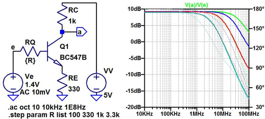
Die Verstärkung für niedrige Frequenzen ist wie vorhergesagt  $-\frac{R_C}{R_E} = \frac{1\text{ k}\Omega}{330\ \Omega} = 3 \approx 9,5\text{ dB}$ . Erwartete Übergangsfrequenz ( $f_T$  – Transitfrequenz der Stromverstärkung):
