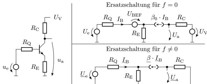
Aus der Ersatzschaltung für  $f \neq 0$  berechnet sich der Frequenzgang.
