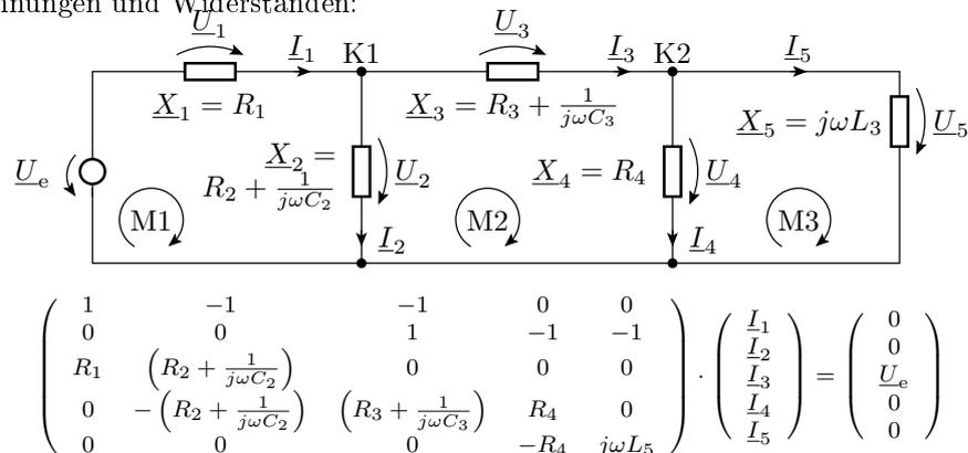
Die Auflösung des Gleichungssystems nach dem Verhältnis  $\frac{U}{I}$  ist der Quotient aus einem Zähler- und einem Nennerpolynom mit  $j\omega$  als Argument:
