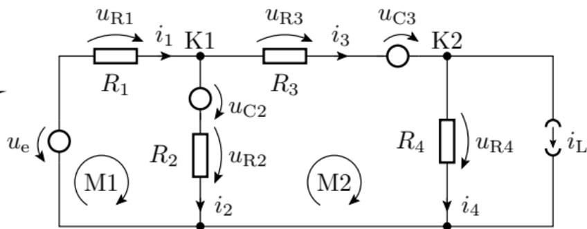
In jedem Zeitschritt erfolgt eine »stationäre Analyse« der Ersatzschaltung und eine Neuberechnung der »Quellenwerte«.
