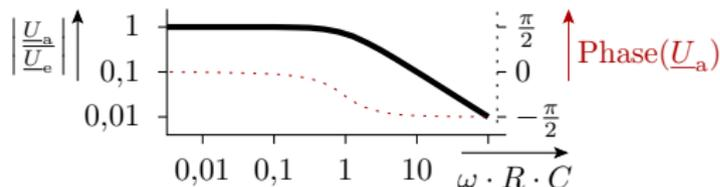
Spannungsteiler mit  $\underline{Z}_1 = R$  und  $\underline{Z}_2 = \frac{1}{j\omega C}$ :
