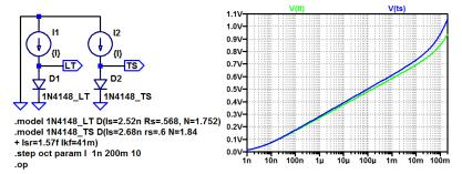
Das Modell des Simulators »\_LT« und das Modell »\_TS« aus [1] verhalten sich auch unterschiedlich. Fertigungsstreuungen? Schaltungen so entwerfen, dass die Unterschiede nicht stören.
