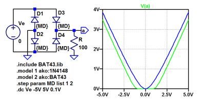
Über den Schottky-Dioden (BAT43) fällt weniger Spannung ab.
