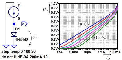
Im Sperrbereich ist der simulierte Strom null.
