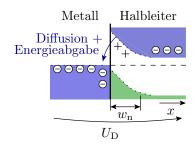
Bei Verbindung eines Metalls mit einer Fermi-Energie  $W_{\rm F}$  mit einem n-dotierten Halbleiter mit einem chemischen Potential  $\zeta>W_{\rm F}$
