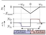
In den Gleichungen zur Bestimmung von w,  $w_{\rm p}$ ,  $w_{\rm n}$  und  $E_{\rm max}$  ist die Diffusionsspannung durch  $U_{\rm Diff}+U_{\rm S}$  zu ersetzen:
