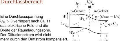
Unter der Annahme, keine Rekombination in der Sperrschicht<sup>2</sup>, behalten die chemisches Potentiale der in das andere Gebiet diffundierenden Ladungsträger die Differenz  $\zeta_n - \zeta_p = q \cdot U_D$ . Vergrößerung von  $n \cdot p$  bis zum Ende der Sperrschicht:
