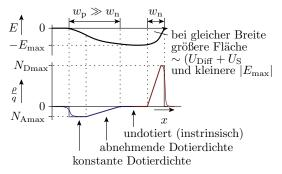
Aus der Poisson-Gl. 2  $\frac{\partial E}{\partial x}=\frac{\rho}{\varepsilon}$  folgt, dass bei abnehmender Raumladung, die in der Verarmungszone gleich der Dotierdichte ist, E schwächer und in einer intrinsischen Zwischenschicht gar nicht zunimmt. Bei gleicher Sperrschichtbreite und Sperrspannung geringeres Feldstärkemaximum.
