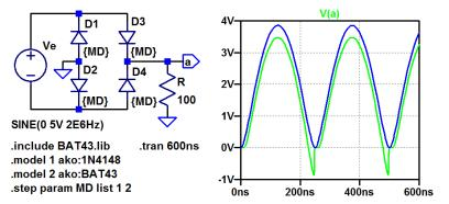
Bei hohen Frequenzen (hier 2 MHz) fließt durch die pn-Dioden nach jedem Polaritätswechsel aufgrund der Diffusionskapazität ein Strom in Sperrrichtung, bei Schottky-Dioden nicht.
