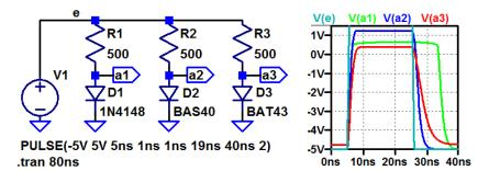
Die Simulationsergebnisse sind nicht vollständig plausibel. Die BAS40 hat eine Flussspannung größer 1 V (sollte nicht mehr als 0,5 V sein) und bei der BAT43 fließt laut Simulation ein Sperrstrom von 0,5 mA (sollte null sein). Nicht jedes Bauteilmodell, das man irgendwo findet, liefert glaubhafte Werte. Nachmessen!
