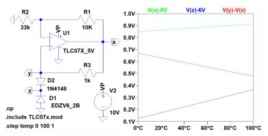
Der OV hält den Strom durch D1 und D2 konstant und bildet
