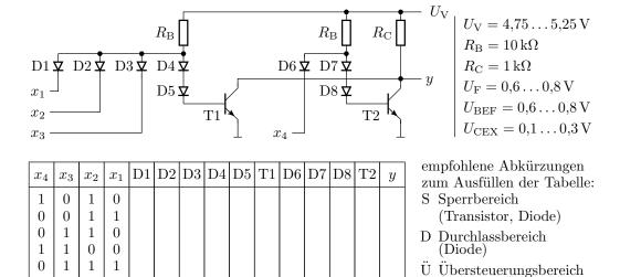
a) Ergänzen Sie in der Tabelle unter dem Bild für die vorgegebenen logischen Eingabewerte für alle Dioden und Transistoren den Arbeitsbereich und für das gesamte Gatter den logischen Ausgabewert y.
