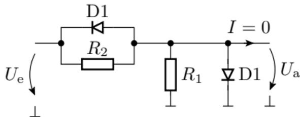
$$D1: U_F = 0,7 \text{ V}, U_{BR} > 100 \text{ V} \quad R_1 = 100 \Omega$$
