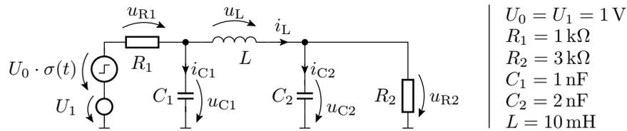
Schätzen Sie die Spannung  $u_{R2}$  für die stationären Zustände vor dem Sprung ( $t < 0$ ), im Sprungmoment ( $t = 0$ ) und lange nach dem Sprung ( $t \gg 0$ ).
