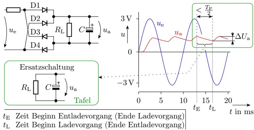
$$\text{Entladefunktion: } u_a(t) = u_a(t_E) \cdot e^{-\frac{t-t_E}{R_L \cdot C}}$$
