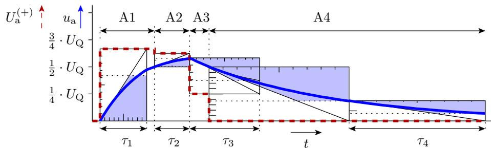
**Glättungskondensator hinter einem Gleichrichter**
