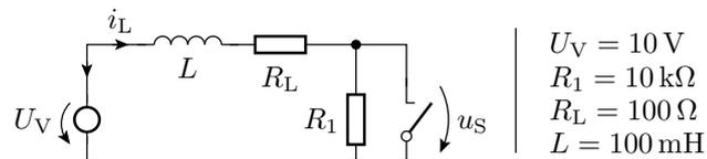
Wie groß ist die Spannung  $u_S$  über dem Schalter im Ausschaltmoment?
