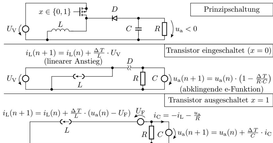
In Phase 2  $i_L$  fließt in umgekehrter Richtung durch  $C$
