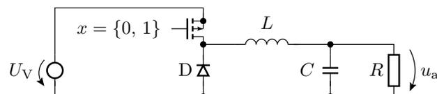
1. Aufstellen der Ersatzschaltungen mit der Kapazität und der Induktivität als Quellen für beide Betriebsphasen.
