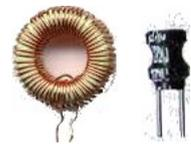
Die Regel, dass die Induktivität sich proportional zur Leitungslänge verhält, gilt nur für gerade Leiter. Bei dem Bauteil Spule umschließt die Leitung den magnetischen Fluss mehrfach:
