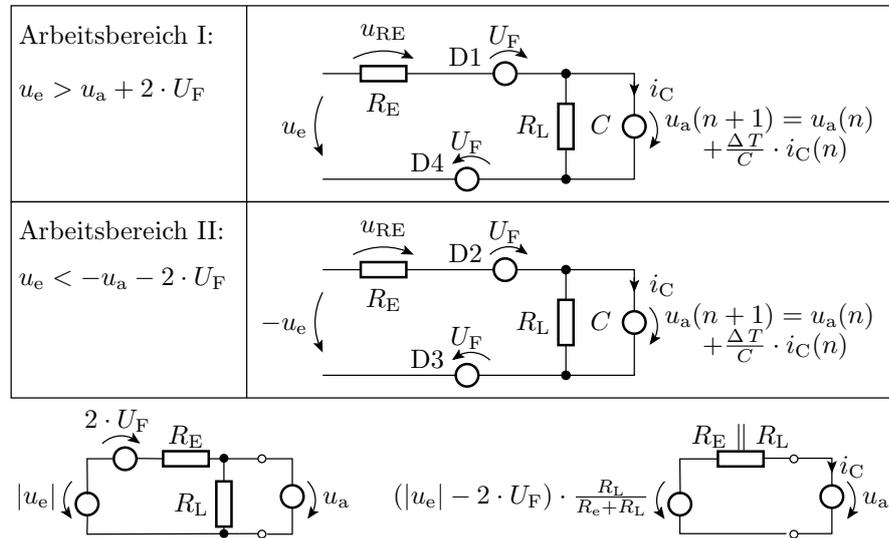
$$i_C(n) = \frac{\frac{R_L}{R_E + R_L} \cdot (|u_e(n)| - 2 \cdot U_F) - u_a(n)}{R_E \parallel R_L}$$
