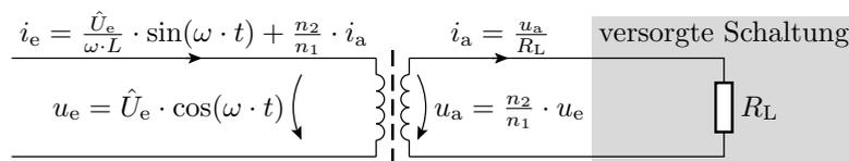
Kompensation des Sekundärstroms  $i_a$  durch einen zusätzlichen Primärstrom  $i_{e1}$  so, dass der den Kern umfließende Strom gleich bleibt:
