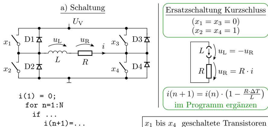
**Ersatzschaltungen mit Versorgungsspannung über der Last**
