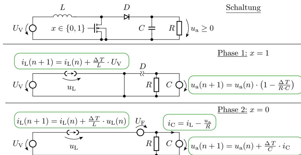
Reglung der Ausgangsspannung über  $\eta_T = \frac{t_{x1}}{T_P}$  ( $t_{x1}$  - Zeit, die  $x$  eins ist;  $T_P$  - Periodendauer).
