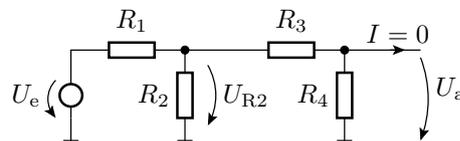
Zusammenfassen von  $R_2$  bis  $R_4$  zu einem Ersatzwiderstand:
