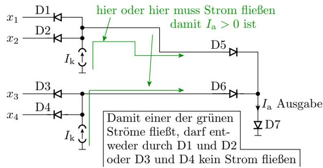
$I_a$  ist nur groß, wenn entweder die Potentiale von  $x_1$  und  $x_2$  größer als  $U_F$  sind oder wenn die Potentiale von  $x_3$  und  $x_4$  größer als  $U_F$  sind. Sonst ist  $I_a = 0$ . Logische Funktion:
