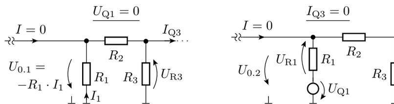
$$U_{0.1} = -R_1 \cdot I_1 = -R_1 \cdot \underbrace{\frac{R_3}{R_1 + R_2 + R_3} \cdot I_{Q3}}_{I_1 \text{ nach Stromteiler}}$$
