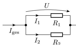
Ströme durch Widerstände, über denen dieselbe Spannung abfällt, verhalten sich umgekehrt proportional zu den Widerstandswerten:
