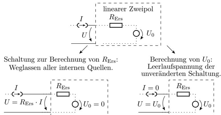
Der Ersatzwiderstand eines Zweipols ist der Ersatzwiderstand des Widerstandsnetzwerks, das übrig bleibt, wenn die Werte aller Quellen auf null gesetzt werden.
