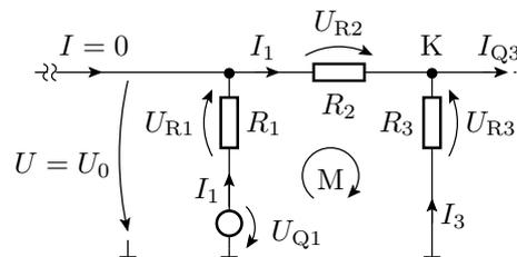
$$\begin{pmatrix} 1 & 1 \\ (R_1 + R_2) & -R_3 \end{pmatrix} \cdot \begin{pmatrix} I_1 \\ I_3 \end{pmatrix} = \begin{pmatrix} I_{Q3} \\ U_{Q1} \end{pmatrix}$$
