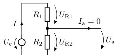
Werden zwei Widerstände vom gleichen Strom durchflossen, verhalten sich die Spannungsabfälle proportional zu den Widerständen:
