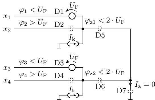
$$\varphi_{z1} = \varphi_1 + U_F < 2 \cdot U_F \Rightarrow D5 \text{ sperrt}$$
