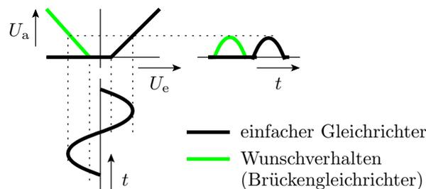
Der einfache Gleichrichter schneidet von einer Wechselspannung die untere Halbwellen ab.
