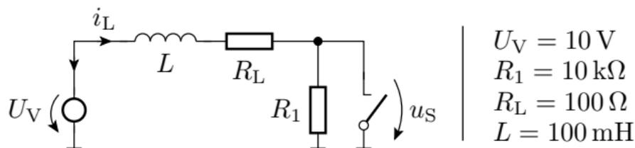
Wie groß ist die Spannung  $u_S$  über dem Schalter im Ausschaltmoment?
