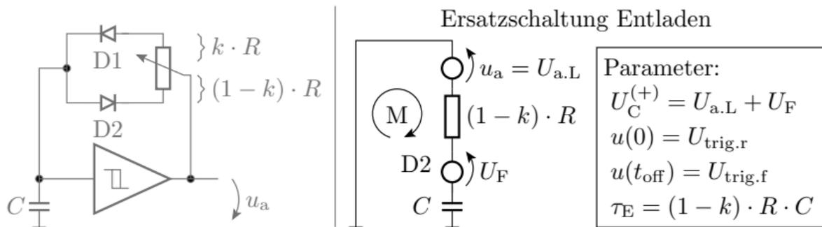
$$t_{\text{off}} = (1-k) \cdot R \cdot C \cdot \ln \left( \frac{U_{a.L} + U_F - U_{\text{trig.r}}}{U_{a.L} + U_F - U_{\text{trig.f}}} \right)$$
