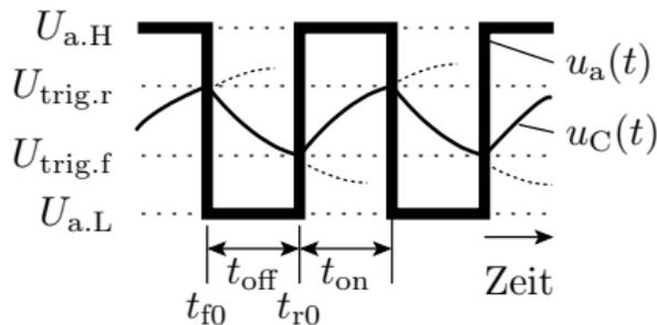
Entladezeit  $t_{\text{off}}$ , in der die Ausgangsspannung »0« ist:
