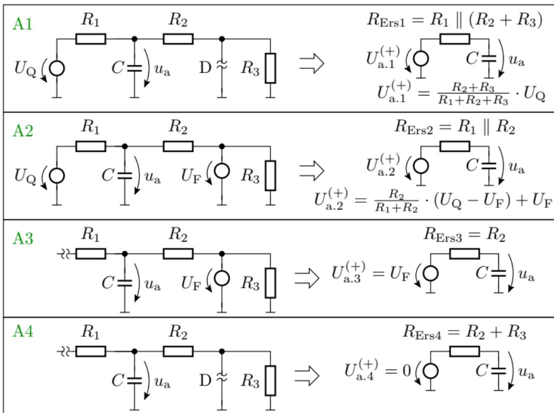
$U_{a.i}^{(+)}$ ,  $\tau_i$  für  $R_1 = R_2 = R_3 = R$  und  $U_Q = 4 \cdot U_F \Rightarrow$  **Tafel**
