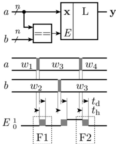
Laut Zielfunktion wird der Wert von  $a$  gespeichert, wenn er mit dem von  $b$  übereinstimmt. Das dargestellte Simulationsmodell ohne Zeitverhalten verhält sich auch so, aber mit Verzögerungszeiten andere Funktion (nicht laufzeittolerant).
