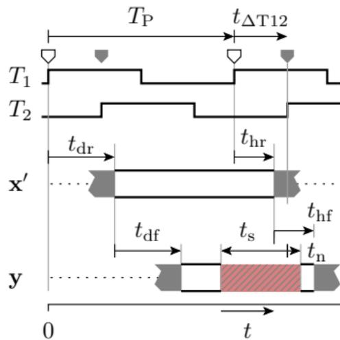
Die Taktflanken zwischen Eingangs- und Ausgangsregister können um einen Zeit  $t_{\Delta T12}$  versetzt sein, absichtlich zur Erhöhung der max. Taktfrequenz oder unbeabsichtigt durch unterschiedliche Verzögerungen von der gemeinsamen Taktquelle.
