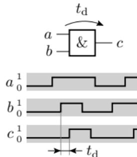
Über **generic** können der Entwurfseinheit bei der Instanziierung Parameter zugeordnet werden, im Beispiel die Verzögerungszeit. Wird in den von unserem Entwurfssystem generierten Post-Place-and-Route-Simulationsmodellen genutzt.
