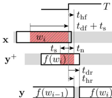
Für  $t_{hf} > t_n$  ist die Kontrolle der Gültigkeit komplizierter.
