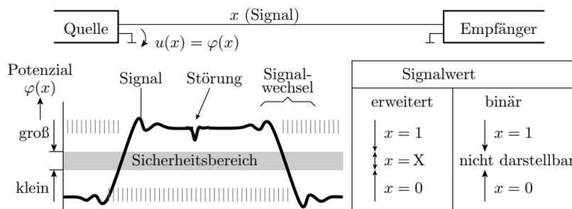
Ein Signal ist ein zeitlicher Werteverlauf einer physikalischen Größe. Binäre Signale unterscheiden zur Informationsdarstellung zwei Werte: klein und groß, 0 und 1 oder falsch und wahr. Die physikalischen Trägergrößen Strom und Spannung können sich nicht sprunghaft ändern. In den Zeitfenstern von Werteänderungen sind binäre Signale ungültig.
