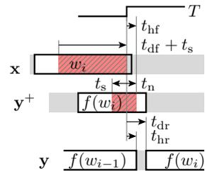
Für  $t_{hf} > t_n$  ist die Kontrolle der Gültigkeit komplizierter.
