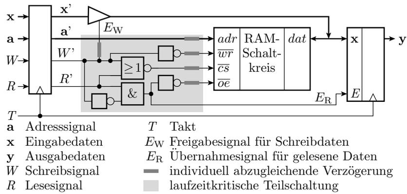
Für die Nutzung eines SRAMs ist eine Schnittstellenschaltung mit den Registern und dem grau unterlegten laufzeitkritischen Teil zu entwickeln<sup>11</sup>.
