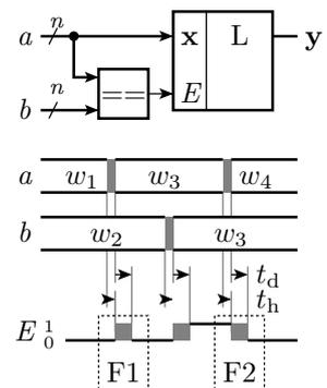
Fehlersituation F1: Bei einer Änderung von  $a$  ist dessen Wert ungültig. Dabei ist nicht für jede Änderung ausschließbar dass er kurzzeitig gleich dem von  $b$  ist und das Latch den Wert  $w_3$  oder den ungültigen Wert davor übernimmt.
