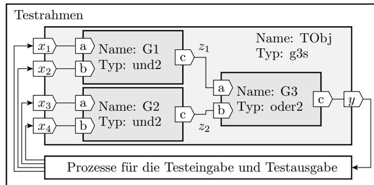
Digitale Systeme werden hierarchisch aus Teilschaltungen zusammengesetzt. Jede Teilschaltung hat eine Schnittstelle, die die Anschlussignale definiert. Eine Strukturbeschreibung hat auch eine Schnittstelle, definiert interne Signale und beschreibt für jede Teilschaltung, mit welchen Signalen deren Anschlüsse verbunden sind. Das oberste Hierarchie-Element ist der Testrahmen.
