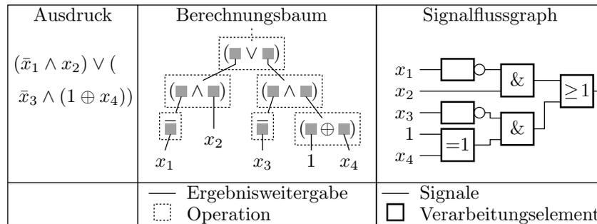
Ein Ausdruck kann nicht nur einen Berechnungs- sondern auch einen Signalfluss beschreiben. Aus den Operatoren werden Gatter und aus den Eingaben, Zwischenergebnissen und dem Ergebnis Signale. Eine Minimierung der Operationen im Ausdruck minimiert die Gatteranzahl der korrespondierenden Schaltung.
