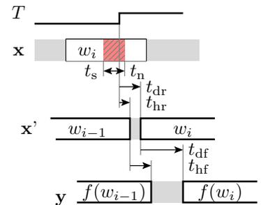
( $t_{hf}$ ,  $t_{df}$  – Halte- und Verzögerungszeit der Verarbeitungsfunktion;  $t_s$ ,  $t_n$ ,  $t_{hr}$ ,  $t_{dr}$  – Vorhalte-, Nachhalte-, Halte- und Verzögerungszeit des Registers.)
