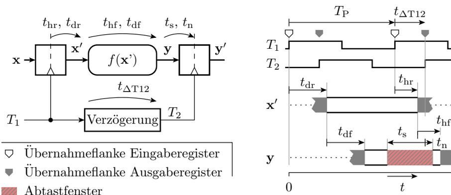
Die Taktflanken zwischen Eingangs- und Ausgangsregister können um einen Zeit  $t_{\Delta T12}$  versetzt sein, absichtlich zur Erhöhung der max. Taktfrequenz oder unbeabsichtigt durch unterschiedliche Verzögerungen von der gemeinsamen Taktquelle.
