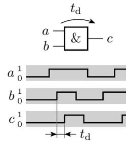
Über `generic` können der Entwurfseinheit bei der Instanziierung Parameter zugeordnet werden, im Beispiel die Verzögerungszeit. Wird in den von unserem Entwurfssystem generierten Post-Place-and-Route-Simulationsmodellen genutzt.
