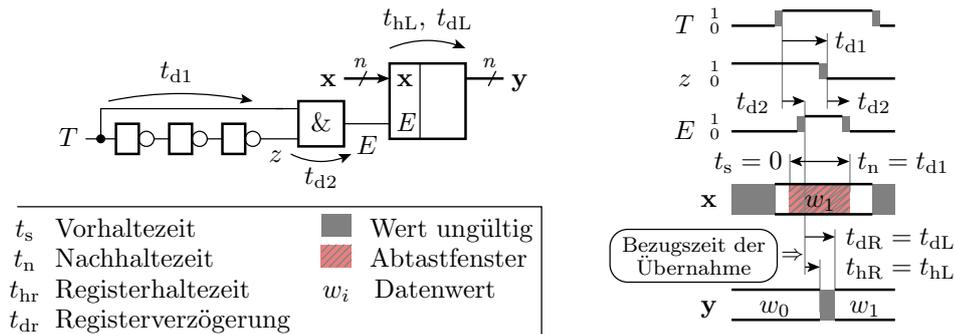
Erzeugung eines kurzen Freigabeimpulses für ein Latch an der aktiven Taktflanke. Halbe Latch-Anzahl gegenüber Master-Slave-Lösung. Empfindlicher gegenüber Laufzeitungenauigkeiten, d.h. schwerer zu entwerfen. Eingabedaten brauchen keine Vorhaltezeit ( $t_s = 0$ ), dafür eine Nachhaltezeit ( $t_n > 0$ ).
