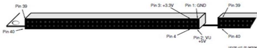
Jede 40-Pins Expansion überschreibt, gezeigt in die Bild, Gebrauch 0.1 Zoll (Mil 100) BAD-Abstand. Pin 1 von jedem Stecker ist immer Boden. Ähnlich ist Pin 2 immer das +5V DC, das vom Schaltung Spg. Versorgungsteil ausgegeben wird. Pin 3 ist immer der Ausgang vom +3.3V DC Regler. Wir haben B1 als die Schnittstelle für Data übertragung.
