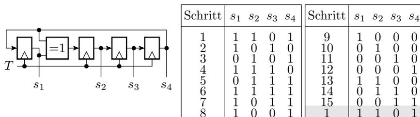
Abbildung 2: Linear rückgekoppeltes 4-Bit-Schieberegister
