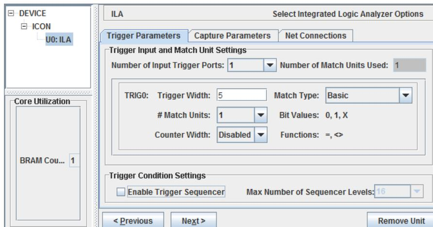
Abbildung 7: Triggerparameter für den integrierten Logikanalysator
