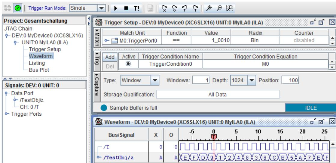
Abbildung 10: Aufzeichnungsergebnis des Logikanalysators für den schnellen Takt
