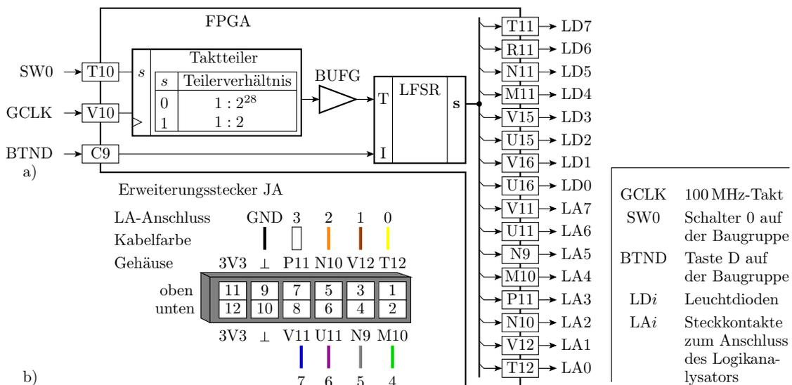
Abbildung 4: a) Gesamtschaltung b) Erweiterungsstecker JA zum Anschluss des Logikanalysators
