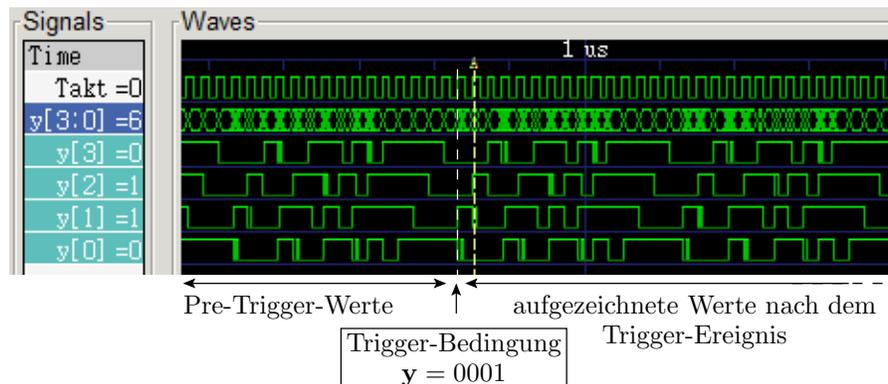
Abbildung 5: Aufzeichnungsergebnis des Logikanalysators für den schnellen Takt (Die mit »A« gekennzeichnete Trigger-Line wird ein Takt zu spät eingezeichnet. Vermutlich ein Fehler.)
