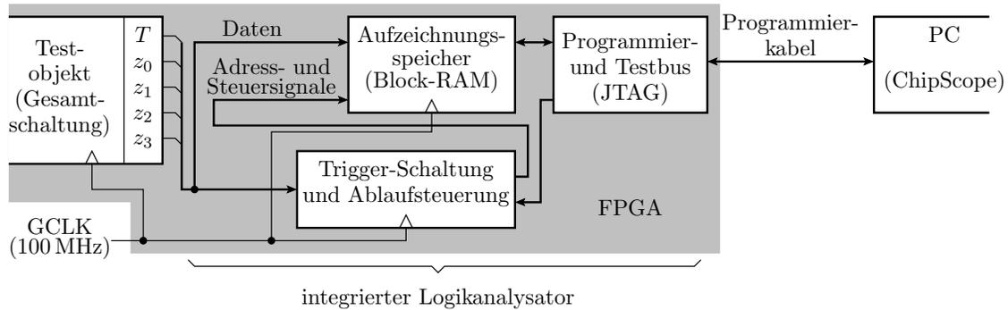
Abbildung 6: Test der Beispielschaltung mit einem integrierten Logikanalysator
