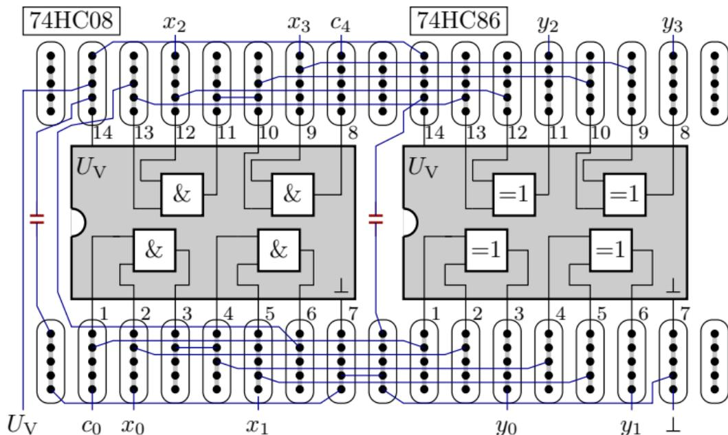
Anordnung auf einem Steckbrett. Blau gesteckte Drahtbrücken, rot Stützkondensatoren. Eingerahmte Punkte sind intern verbunden.
