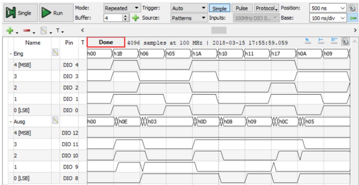
Im Beispiel werden alle Ein- und Ausgangssignale mit 100 MHz, d.h. mit 10 Werten je Eingabeänderung aufgezeichnet. Damit sind Verzögerungen mit einer Auflösung in 10ns-Schritten erkennbar.
