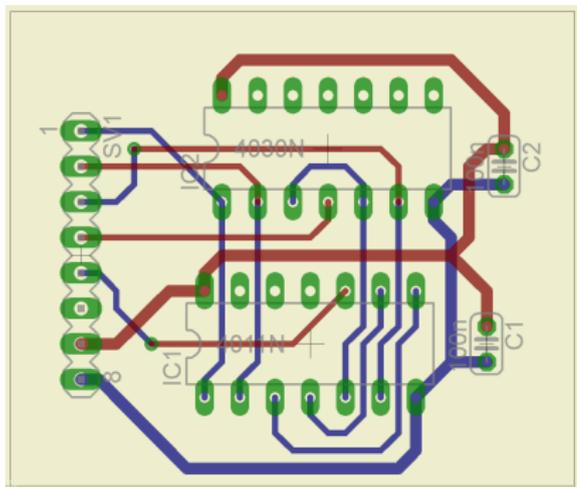
(blau – Unterseite, rot – Oberseite; grün – Lötäugen, bei zweiseitigen Leiterplatten mit Durchkontaktierungen (Vias)).
