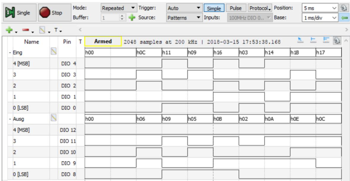
Ein Logikanalysator zeichnet digitale Abtastwerte auf. Erforderliche Einstellungen: abzutastende Signale, Abtastfrequenz, Trigger (Bedingung für den Aufzeichnungsbeginn), ...
