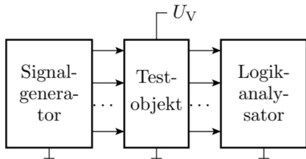
Zum Test des logischen Verhaltens werden die Eingaben über Schalter angelegt und die Ausgabewerte mit Leuchtdioden oder einem Multimeter überwacht. Kontrolliert wird die Funktion nach der Wertetabelle. Bei einem Test des Zeitverhaltens werden die Eingaben in Echtzeit von einem Signalgenerator erzeugt und die Ausgabe mit einem Logikanalysator aufgezeichnet. Dabei werden zusätzlich die Signalverzögerungen kontrolliert.
