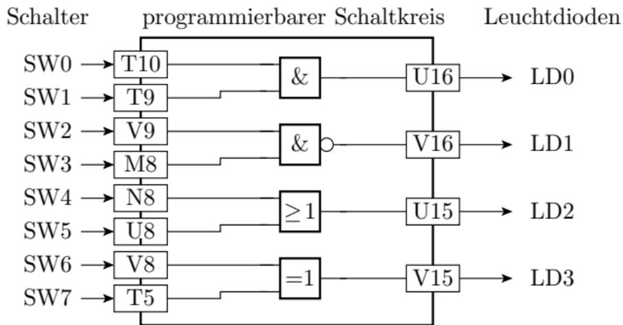
Im ersten Beispiel sollen vier Gatter so einprogrammiert werden, dass die Eingänge von Schaltern steuer- und die Ausgänge mit LEDs beobachtbar sind. Die Kästchen mit »T10« etc. sind die Bezeichner der Schaltkreisanschlüsse, an denen die Schalter und LEDs auf der Baugruppe angeschlossen sind.
