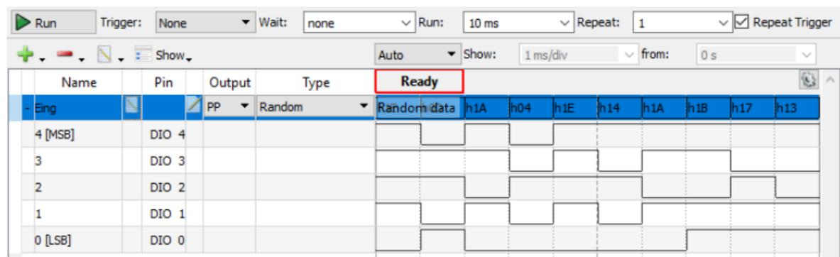
Im Beispiel bilden die Eingänge  $x_0$  bis  $x_3$  einen Bus und  $c_0$  ist ein Einzelsignal. Für alle Eingabesignale ist eingestellt »10 MHz« und Zufallssignale. Nach Konfiguration starten mit »Run«.
