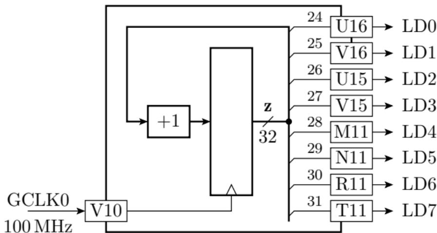
An Pin »V10« liegt auf der Baugruppe der 100MHz-Takt an. Dieser soll mit einem 32-Bit-Zähler gezählt und die höchstwertigen 8 Bit auf LEDs ausgegeben werden. Jedes Zählbit halbiert den Takt:
