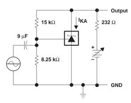
TEST CIRCUIT FOR VOLTAGE AMPLIFICATION
