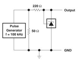
**TEST CIRCUIT FOR PULSE RESPONSE**
